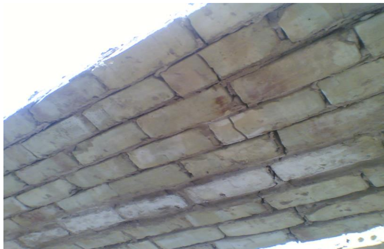
شكل رقم (6) يوضح الشقوق نتيجة لتحميل القوس بحمل يعادل 3 إضعاف الحمل التصميمي
